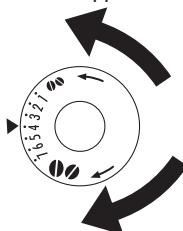
Для обеспечения более медленной подачи кофе и улучшения вида пенки поверните ручку против часовой стрелки (более мелкий помол).
