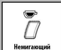
**i** Перед подачей кофе проверить, чтобы зеленый светодиод температуры готовности "☕" был включен, немигающий, что бак для воды и емкость для кофе были наполнены.
