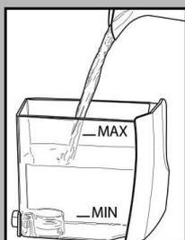
10 Тщательно ополоснуть бак и наполнить его свежей питьевой водой.
