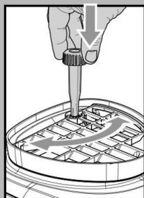
**!** **Запрещается вводить любой материал, отличающийся от кофе в зернах. Кофемолка имеет компоненты в движении, которые могут представлять опасность; запрещается вставлять пальцы и/или предметы. Разрешается только регулировать степень помола посредством специальной ручки. Перед началом операции в емкости для кофе, по любой иной причине, выключить машину и нажать на кнопку ON/OFF и извлечь вилку из розетки. Не вводить кофе в зернах, когда кофемолка в действии.**
