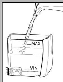
**!** В бак наливать всегда только свежую негазированную воду. Горячая вода а также другие жидкости могут повредить бак и/или машину. Не включать машину без воды: убедиться в том, чтобы было достаточно воды в баке.
