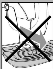
**!** НИКОГДА не убирать поддон для сбора капель при включенной машине. Подождать пару минут после включения и/или выключения, поскольку машина выполняет цикл ополаскивания/самоочистки (см. параграф “Цикл ополаскивания/самоочистки”).
