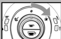
8 Повернуть переключатель по часовой стрелке до достижения точки "☕". Начнется цикл ополаскивания машины.
