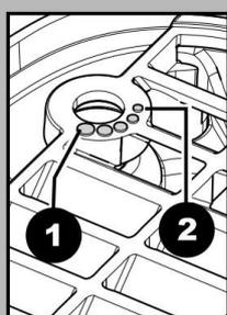
Нажать и повернуть штырь только на один поворот за раз и подать 2-3 кофе; только таким образом можно заметить изменение степени помола.
