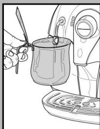
7 Освободить емкость, использованную для восстановления жидкости, выходящей из машины, и установит ее под трубкой пара.
