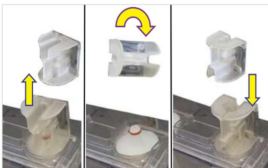
3. Снимите поворотный адаптер с всасывающего штуцера.
