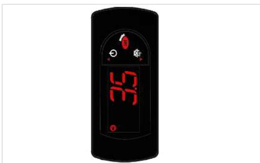
⇒ Отображается текущая температура в холодильной камере.
