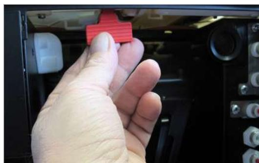
5. Задвиньте блокировочную задвижку до упора.
