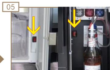
05 Выключите дополнительное оборудование и отсоедините его от источника питания.
