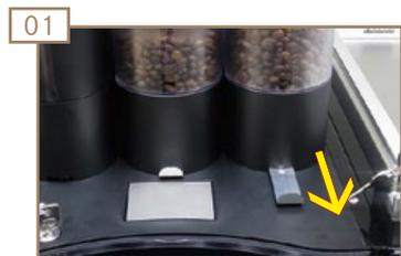
01 Sicherheitsschieber bis zum Anschlag nach vorn ziehen.
